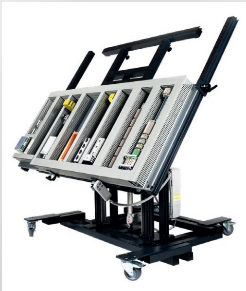
Abbildung 14: AMTE250 mit Tischverbreiterung und aufgelegter Montageplatte
