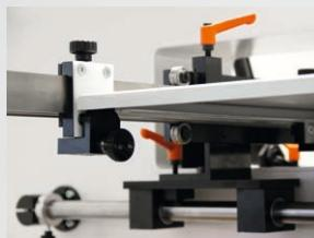
*Sistema di bloccaggio rapido reciproco per la bordatura a scelta sopra o sotto.*
