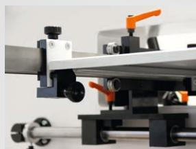
*Wechselseitiges Schnelleinspannsystem für Abkantungen
